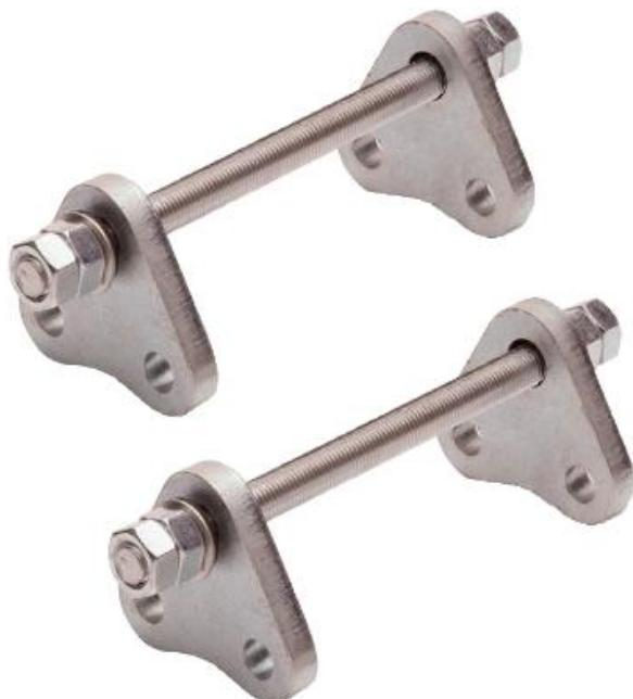
Контрольные (ограничительные) стержни, PN10 (Артикул 508) предназначены для недопущения запрещенных режимов работы виброкомпенсаторов, таких как одновременная работа на растяжение и сдвиг.
