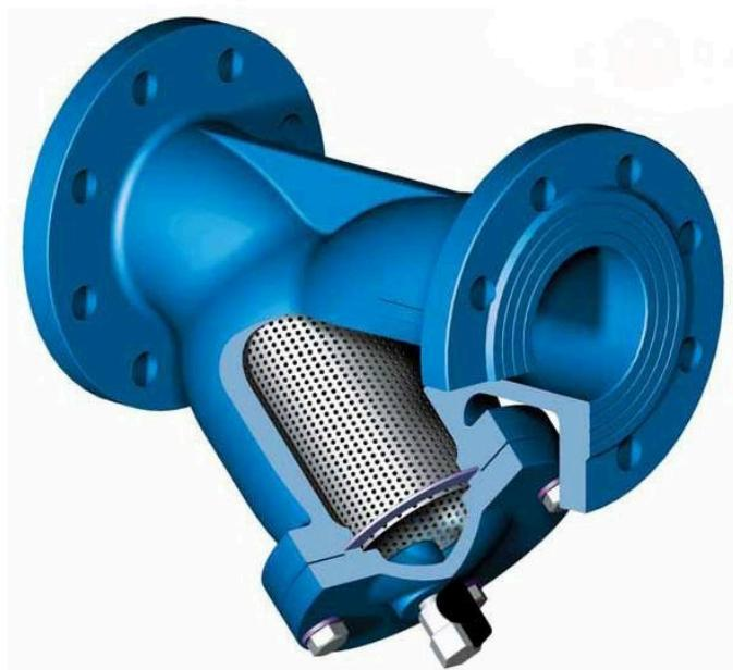
Фильтр сетчатый чугунный фланцевый с магнитной вставкой (Артикул 601) применяются для защиты технологического оборудования от попадания механических частиц, иного крупного мусора, а также посторонних предметов, оставленных после монтажа. Способствуют более качественной очистке среды, проходящей по трубопроводу, в том числе для улавливания примесей металлов, ржавчины, окалины. Предназначены для установки в системах водоснабжения, теплоснабжения, пожаротушения, холодоснабжения.
